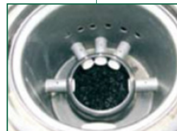
Sistema distribuidor de agua
